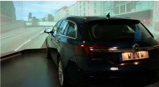
BILD 8. Statischer Fahrsimulator der WIVW GmbH mit Opel Insignia Mock-up.
