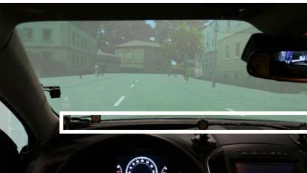
BILD 9. Darstellung der Fahrerperspektive im Mock-up. Die weiße Markierung verdeutlicht die Position des LED-Streifens entlang der Scheibenwurzel.
