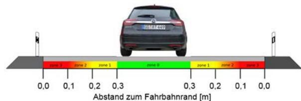
BILD 6. Parameter zur Realisierung der Informationen/Warnungen für den Engstellenassistenten.
